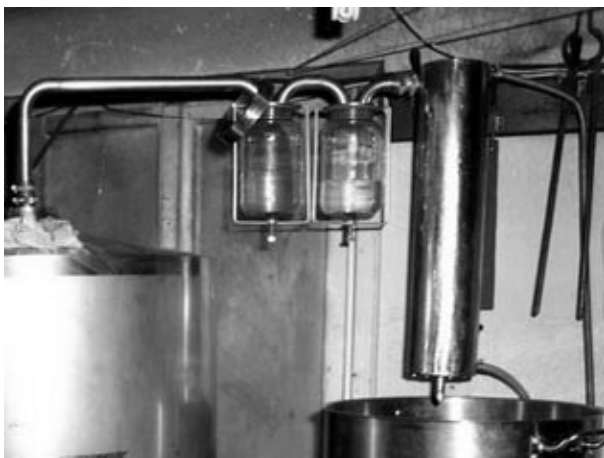
Profesjonalna bimbrownia zarekwirowana przez policję. Na zdjęciu widać kocioł, szklane odstojniki, pionową chłodnicę i garnek – zbiornik na spirytus. Fot. z archiwum KPP Sierpc
