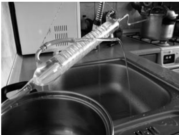
Prosta destylarnia domowa oparta na sprzęcie kuchennym i chłodnicy laboratoryjnej. Fot. autor
